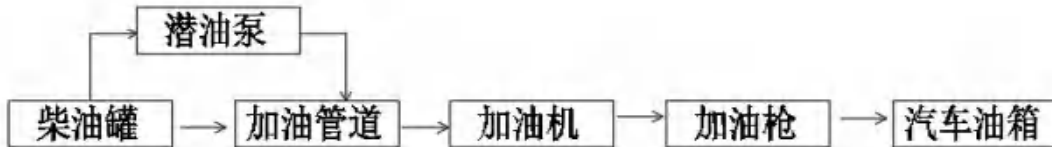
图 2-6 柴油加油工艺流程示意图
